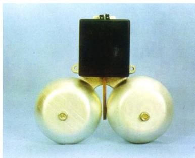
Primenjuje se za unutrašnju montažu u školama, fabrikama... Zvono je bez električnih kontakata i ne stvara električne varnice niti prouzrokuje radio smetnje
